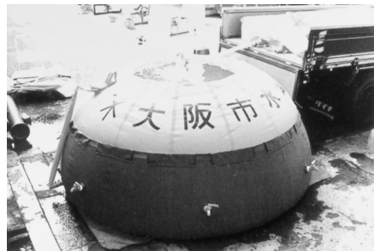
▲ゴム製の仮設水槽。大阪市内に300基設置されています
